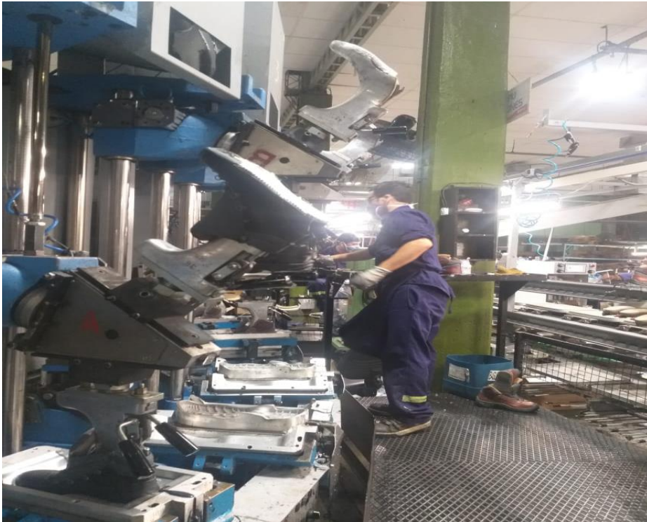
Raspado manual y aplicación de desmoldante
