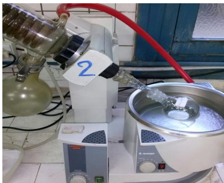
Figura 13: Secado de la muestra con Rotavapor (Laboratorio LISA – UNT)
