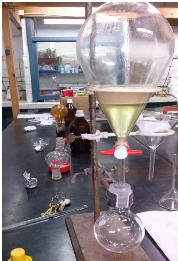
Figura 12: Extracción líquida-líquida de la muestra de mate cebado (Laboratorio LISA – UNT)
