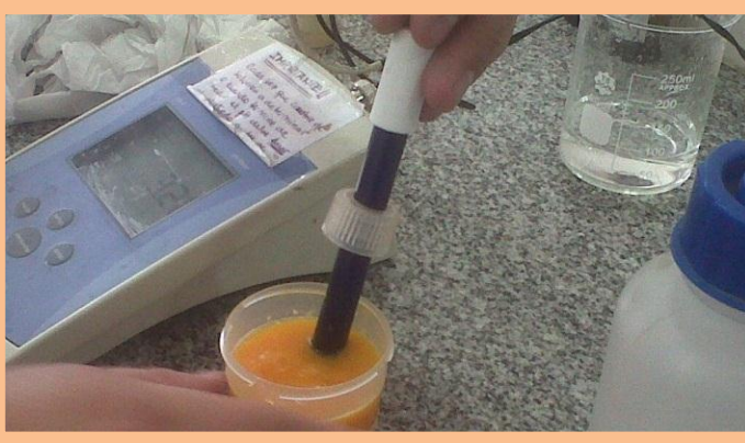
Imagen N° 11: Medición de pH de muestras pasteurizadas a distintas temperaturas.
